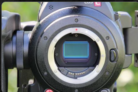
» Kamera používa snímač Super35mm CMOS, vo výbave je aj trojica mechanicky prepínaných filtrov ND
